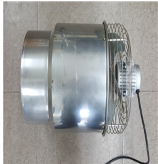
그림 6. 덕트용 플라즈마 발생부 Fig. 6 Duct plasma generator
