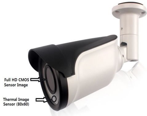
그림 9. 제작된 열상 및 영상 통합 감지센서 카메라 Fig. 9. Manufactured Thermal and Image Integrated Sensor Camera
