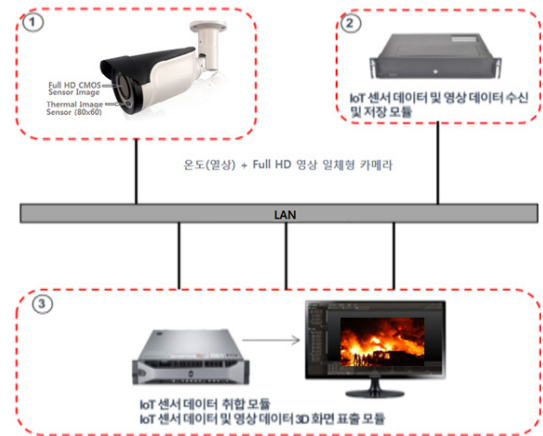
그림 1. IoT 기반 열상 센서와 영상센서를 결합한 CCTV 적용 시스템 구성도
