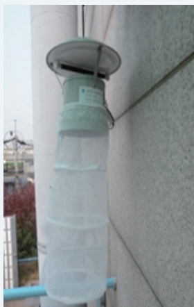
그림 4. 유문등과 디지털모기포집기(DMS) 설치 예
