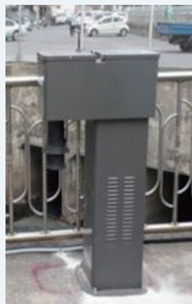
그림 4. 유문등과 디지털모기포집기(DMS) 설치 예
