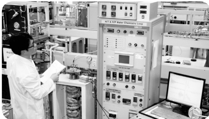
냉각수 기포 음향 방출 탐지 실험 진행 상황을 점검하고 있는 모습.
