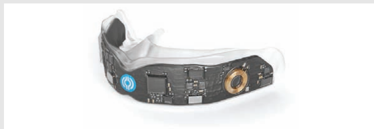
그림 12. 센서와 배터리가 내장된 맞춤형 마우스가드
