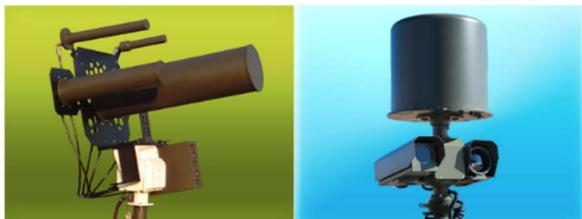
(그림 3) DroneRanger(전파교란기)와 Radar and Camera System
