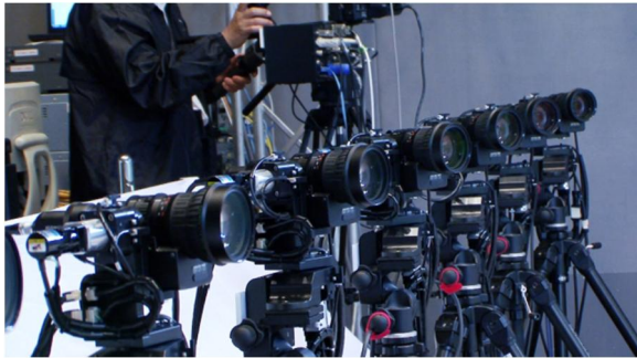
(그림 3) NHK의 다초점 로봇카메라 시스템
