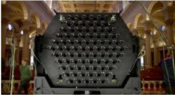
(그림 6) 라이트로 이멀지 카메라 리그 구조[18]
