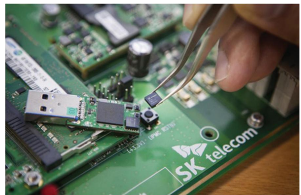
(그림 11) LED 출력 및 CMOS 이미지 센서 기반 양자 난수 생성기
