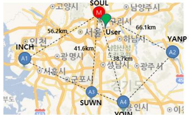
그림 7. Network RTK 기준국과 사용자의 기하학적 배치 Fig. 7. Geometry of network RTK reference and rover stations.
