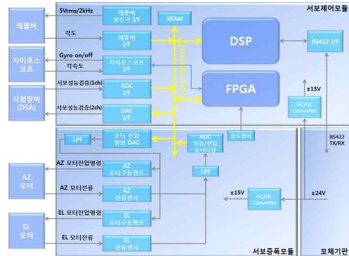
그림 3 서보 시스템 하드웨어 구성 Fig. 3 Hardware configuration of servo system
