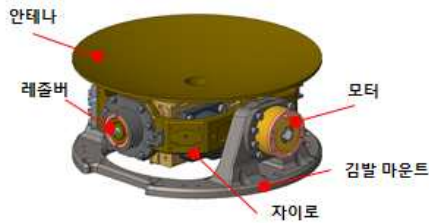
그림 1 제안된 밀리미터 웨이브 탐색기 김발 Fig. 1 Proposed gimbal for millimeter wave seeker
