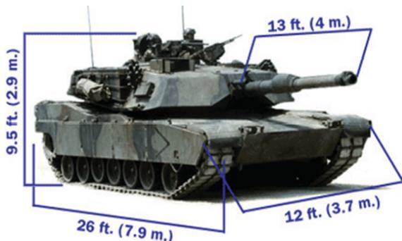
Fig. 12. Dimensions of M1 tank<sup>[14]</sup>
