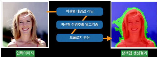
그림 2. 영상의 자동 삼색맵 생성 시스템 Fig. 2. Automatically generation of trimap for video.
