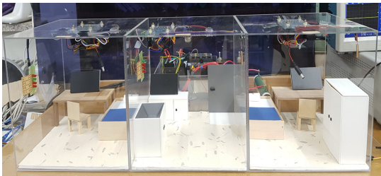
그림 4. 시험 제작된 가스누출 및 화재 경보기 프로토타입과 시험 시스템 사진
