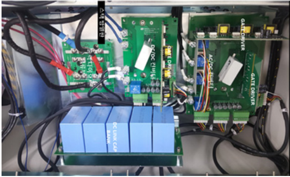
그림 7 제안한 아크램프 전원공급장치의 사진 Fig. 7 The photo of the proposed power supply for arc lamp
