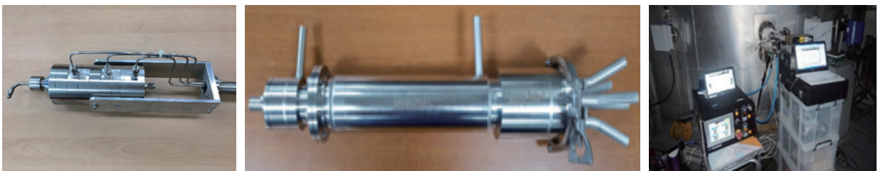
그림 7. 미세먼지 자동연속측정용 입경별 먼지분리장치(좌), 전처리 장치(중) 및 개발시스템(우)
