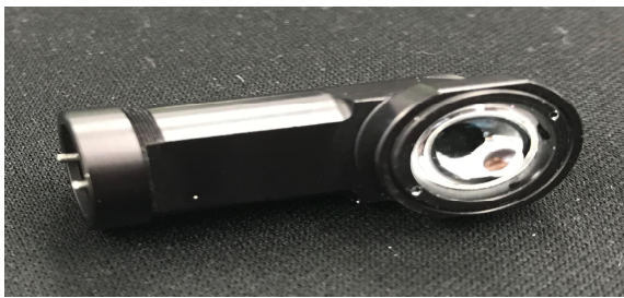
Fig. 9. Appearance Image of Small 360° Oral Scanner Lens. 그림 9. 소형 360° 구강 스캐너 렌즈의 외형 이미지
