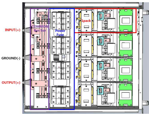
그림 4 제시한 4LEG DC/DC 컨버터의 3D 모델링 Fig. 4 3D modeling of proposed 4 leg DC/DC converter system
