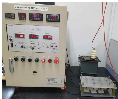
그림 7 부분방전저항성 실험시스템 Fig. 7 Partial discharge resistance test system
