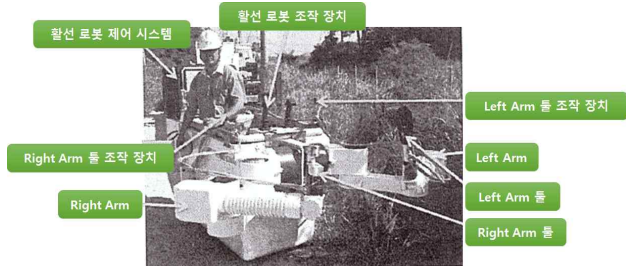
그림 20 양팔형 활선로봇 조작 장치 (버킷 전면부) Fig. 20 Dual-arm live-line robot operating system (the front side of bucket)
