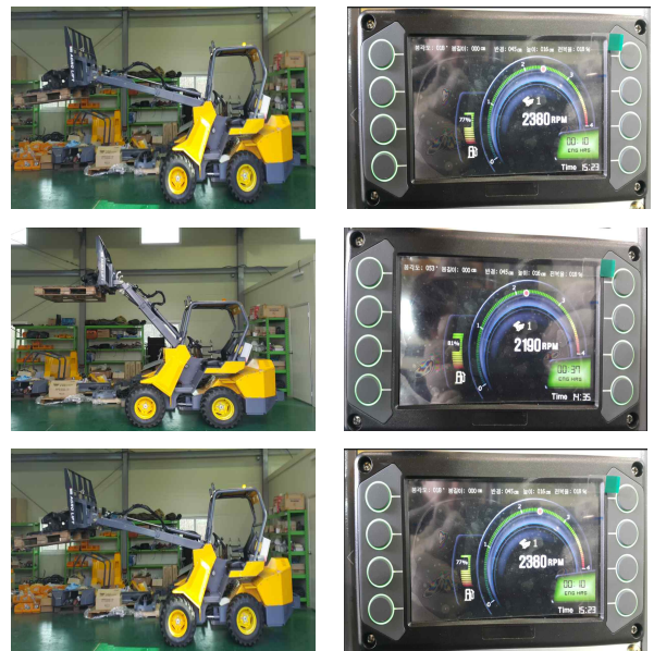
그림 10. 다양한 붐 길이, 각도 및 하중에 따른 데이터 전송 Figure 10. Data Transmission for various length, angle and payload of the boom
