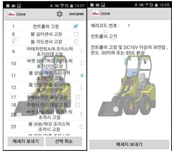
그림 9. 고장코드 전송 Figure 9. Transmission of the Fault Code
