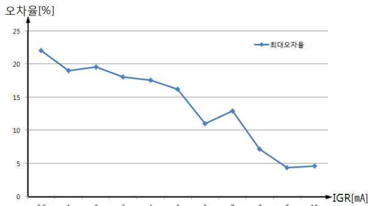
그림 11 유효누설전류 단계의 조건별 최대 오차율 분석결과 Fig. 11 Analysis result of the maximum error rate by condition of the Igr step
