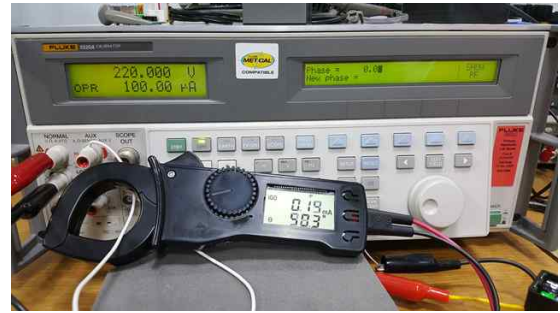
그림 8 표준 교정 장비를 이용한 성능 검증 Fig. 8 Performance verification using standard calibration equipment
