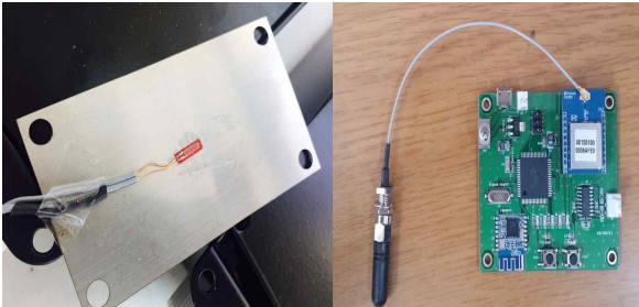
그림 10 스트레인게이지 및 센서 노드 하드웨어 Fig. 10 Strain gauge and the sensor node hardware
