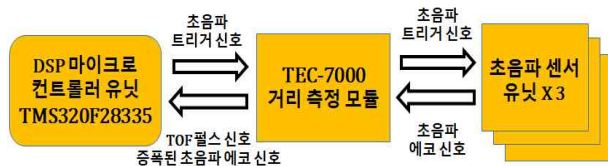
그림 8 초음파 신호처리를 위한 하드웨어 시스템 블록도 Fig. 8 Block diagram of hardware system for ultrasonic signal processing
