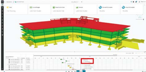
그림 8. AEC분야 5D 구현 예(일정/비용/모델 통합)
