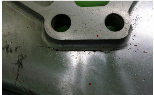
그림 13. 차량용 오일쿨러 불량발생 사례 Fig. 13. A Case Study of Poor Oil Cooler for Vehicle
