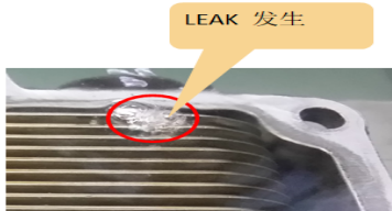
그림 13. 차량용 오일쿨러 불량발생 사례 Fig. 13. A Case Study of Poor Oil Cooler for Vehicle
