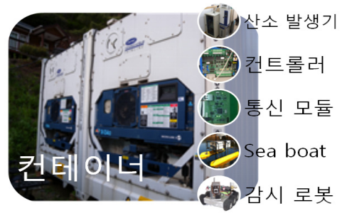
그림 6. 모니터링 시스템이 장착된 컨테이너 Fig. 6. Container with monitoring system
