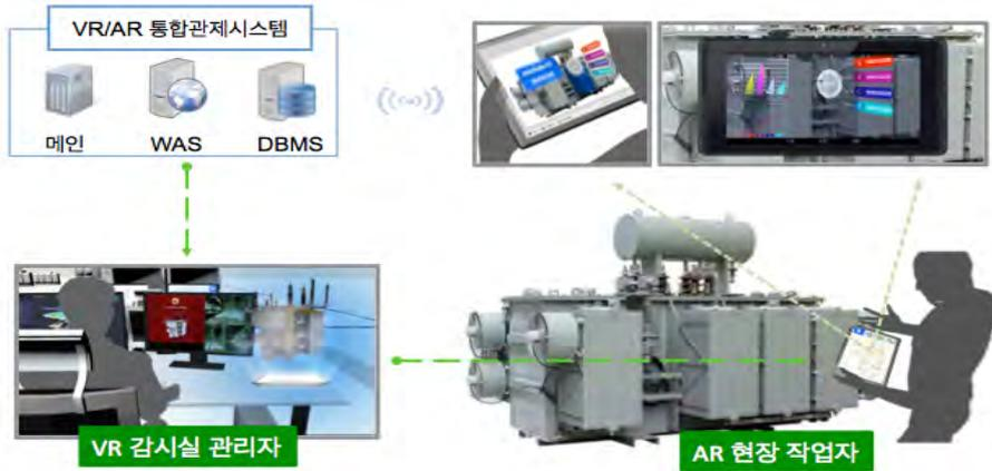
(그림 7) AR/VR 기술을 활용한 전력설비 현장연계 상호작용 서비스 개념도
