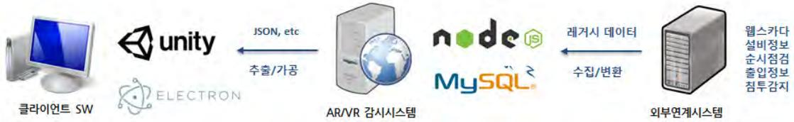
(그림 9) VR·AR 감시시스템 서비스 구조도
