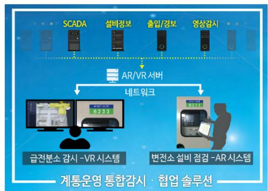
(그림 8) AR/VR변전소 통합 감시시스템 개념도
