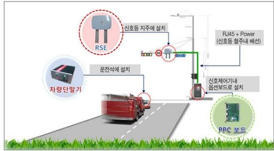
그림 1. 현장식 긴급차량 우선신호 제어시스템
