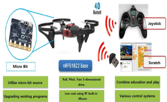
그림 4. 위치 및 자세제어 시스템 Fig. 4 Position and attitude control system
