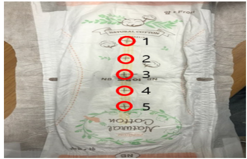
그림 10. 온습도센서 부착 위치 Fig. 10 Location with temperature and humidity sensor
