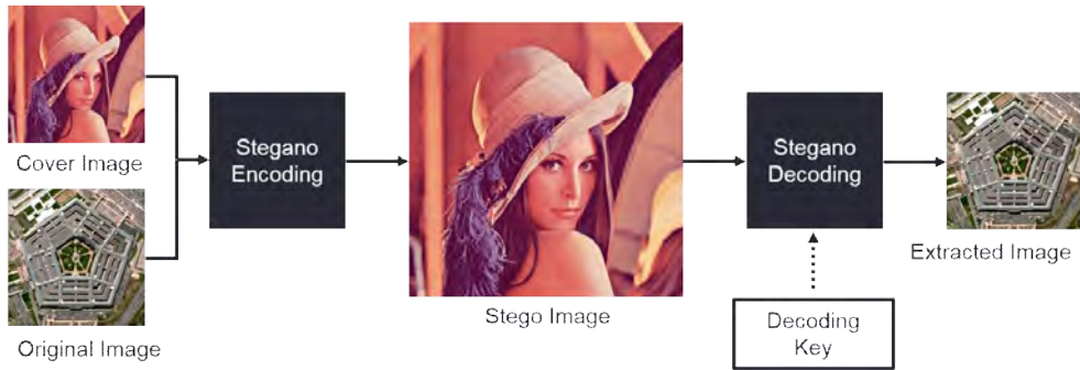
그림 1. 영상 스테가노그래피의 개념 Fig. 1. Image steganography concept
