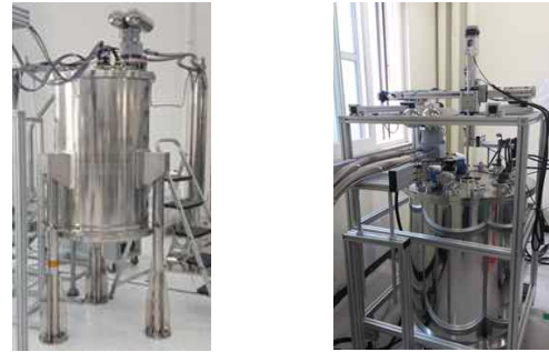
(a) 9.4 T “금속막” 무절연 REBCO NMR 자석 (KBSI 고유 모델) (b) 3 T “금속막” 무절연 REBCO NMR 자석 (KBSI 고유 모델)
