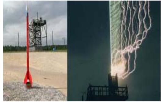
(그림 2) 실험용 낙뢰 유도 로켓(좌) 및 유도 실험장면(우)[12]
