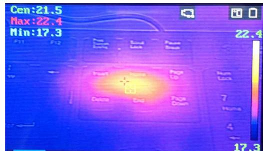
(그림 8) 키보드 표면온도 열화상 측정 결과
