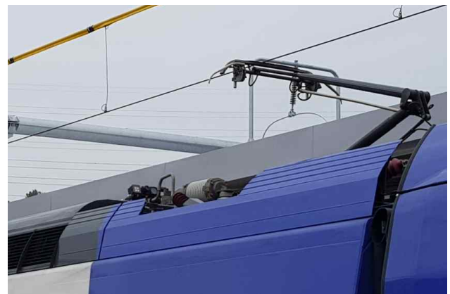
그림 2 KTX-산천의 설치된 상시모니터링 장치[14] Fig. 2 Vedio device of KTX-Sancheon[14]
