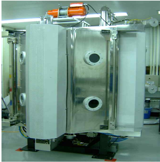
Fig. 5. Experimental setup with sputtering equipment. 그림 5. 스퍼터링 장비의 실험
