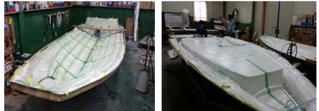
(e) 선체 진공 및 데크 진공시험 (e) Test of a mold and deck vacuum
