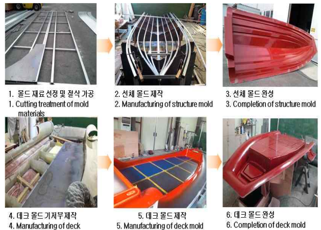
Fig. 8. Mold design and manufacture 그림 8. 몰드설계 및 제작
