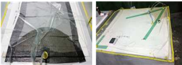
(b) 수지주입 및 흐름도 시험 (b) Flowing test of resin input
