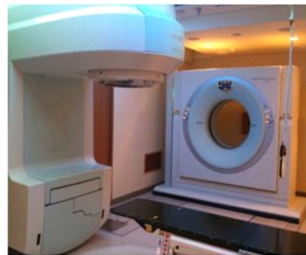
Fig. 2. Medical Linac(Siemens Artiste CT vision).
