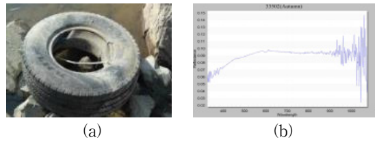
그림 18. 타이어에 대한 (a) 영상과 (b) 반사도 Fig. 18 (a) Image and (b) Reflectance for tire-black in rubber.
