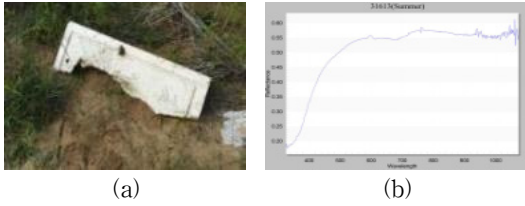
그림 14. 충전재 흰색 스티로폼부이에 대한 (a) 영상과 (b) 반사도
