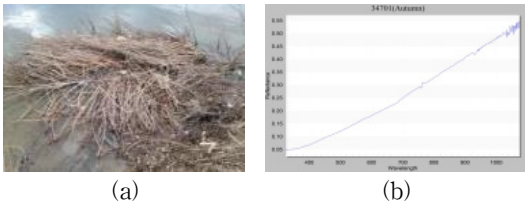
그림 10. 건조한 초목류에 대한 (a) 영상과 (b) 반사도 Fig. 10 (a) Image and (b) Reflectance for dry vegetation.
