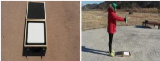
그림 3. 스펙트럴 패널을 이용한 기준반사율 측정 Fig. 3 Reference reflectance measurement using Spectral on panel.
