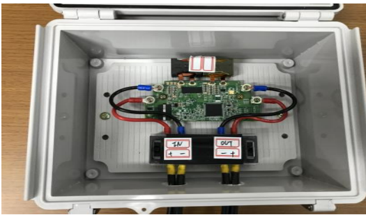
그림 12. 모듈부착형 옵티마이저 Fig. 12 Module mounted power optimizer
