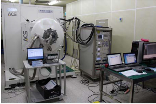
그림 11. 성능분석장치를 사용하여 디지털중계기의 열진공 시험 사진
