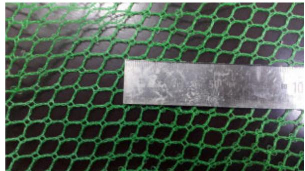
Fig. 6 PE Russel Netting (10mm×10mm)
