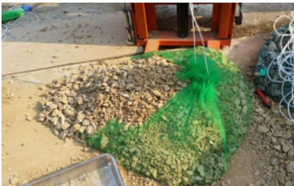
Fig. 15 PE Russel Netting (10mm×10mm)
