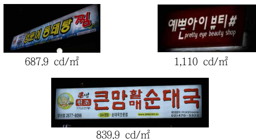
그림 2 내조형 광고조명 측정사례 Fig. 2 Measurement example on internally emitting type
