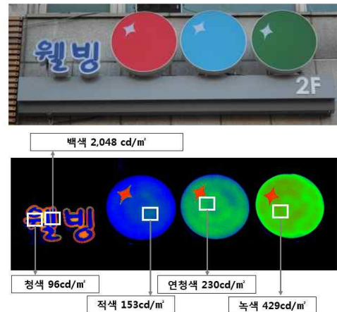
그림 4 채널레터형 색상별 휘도분석 결과 Fig. 4 Luminance analysis results by channel letter type color
