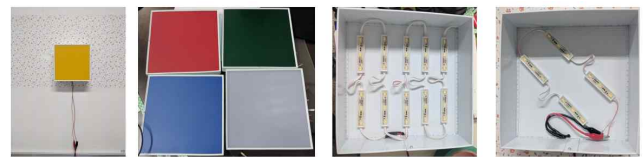
그림 7 채널레터형의 발광면적당 소비전력 측정을 위한 실험세트 구성 Fig. 7 Experimental set for measurement of power density per unit area of channel-letter type
