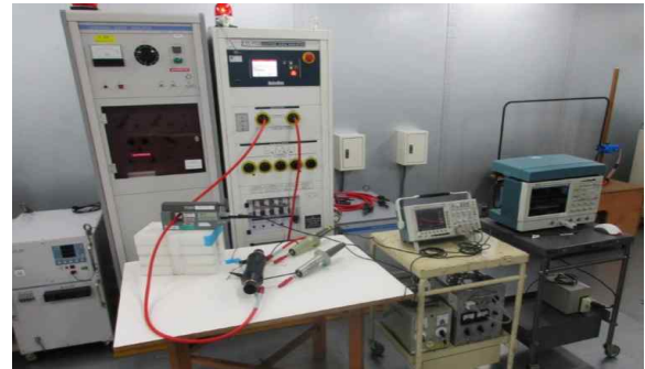
그림 3 직선접속재 특성임피던스 실측 실험 전경
