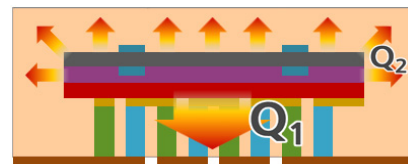
열전달 계수가 높은 봉지재 & 낮은 HGE (Q1, Q2) → 열전소자 성능 저하
