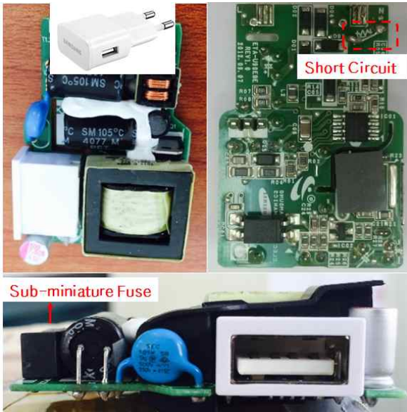
그림 2 스마트폰 충전기 내부 구조(단락 시험) Fig. 2 Structure of SMPS for smart phone(Open short circuit test)
