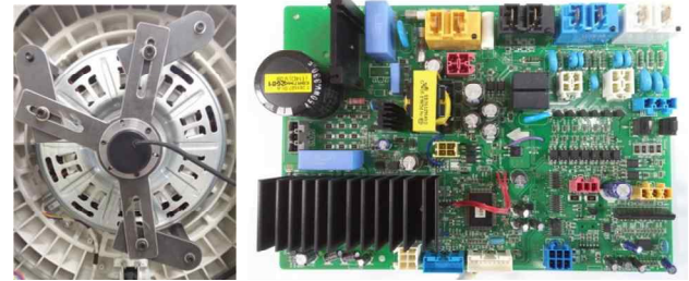
그림 6 사용된 엔코더와 조립된 모터와 제어기 탑재 보드 Fig. 6 Used encoder assembled motor and board with controller
