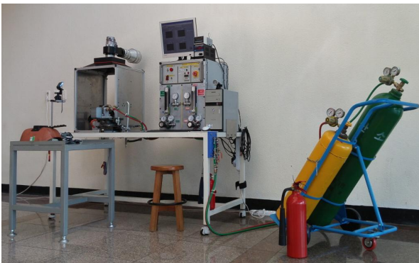
그림 2. 개발한 산소-아세틸렌 토치 시험장치 Fig. 2. The developed Oxy-acetylene torch test equipment.
