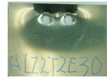
(b) Curling+Tensile crack (ALZ2T2E30)
